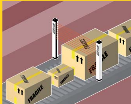
测量传送系统中的物体高度
