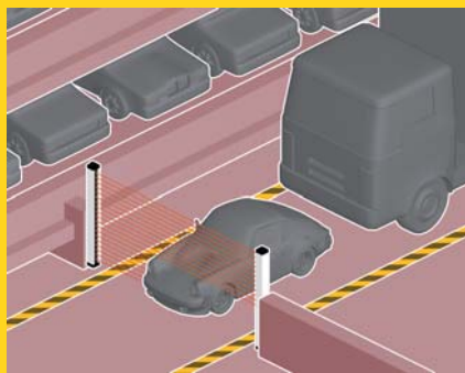
检测自动化停车库内的车辆整体尺寸是否超限
